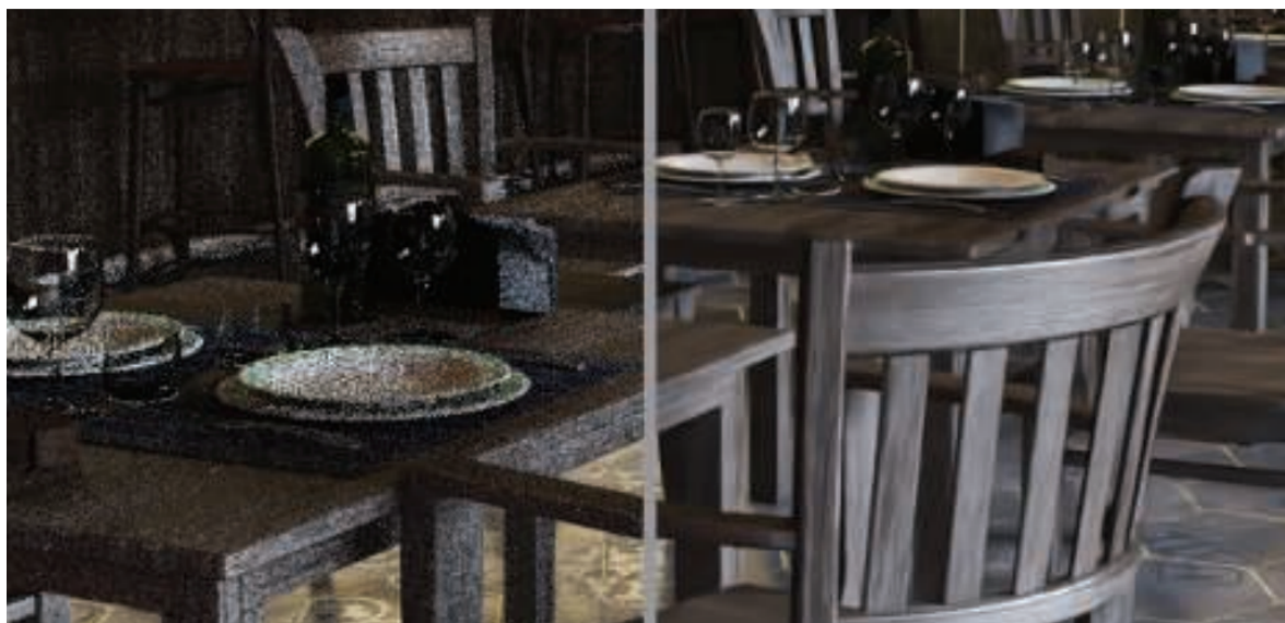
图 24.2：基于神经网络的图像重建。左边是通过路径追踪生成的噪声图像。在右边的图像中，使用 GPU 加速的降噪算法，可以以交互式的速度来对图像进行处理。 [200]
